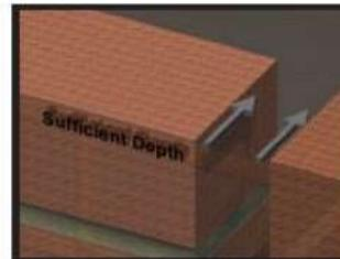
**NOTA:** Deje suficiente profundidad para que el material se empotre 1/8"–1/4" en la junta.
